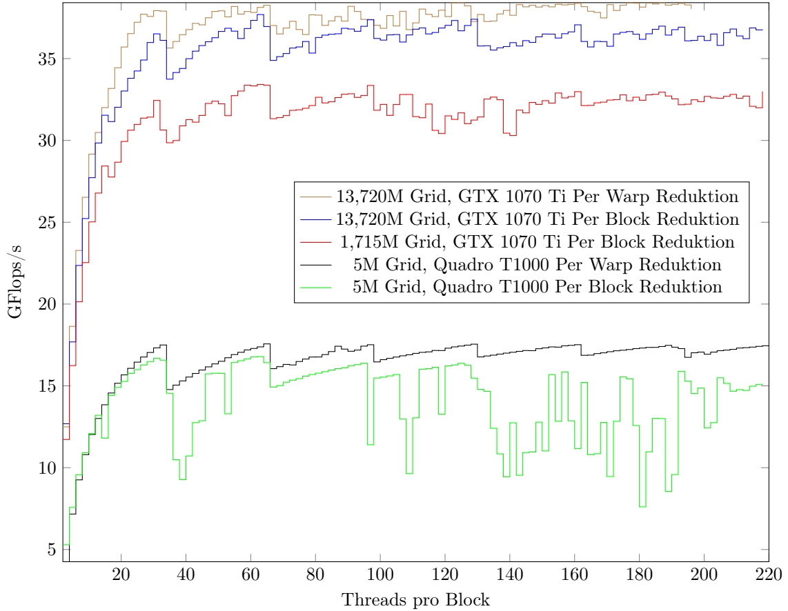
Abbildung 7: GFLOPS/s in Abhängigkeit von verschiedenen Blockgrößen(zwei bis 220).
